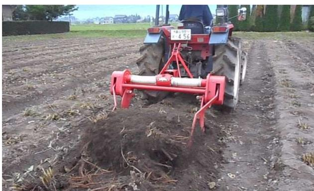
写真11 掘取り機による掘取り
