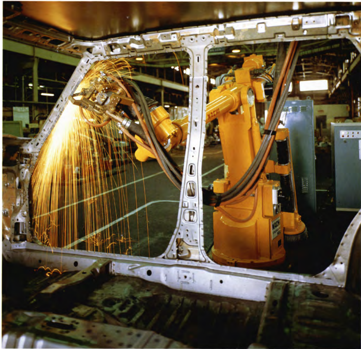
エレクトロニクス化の伸長めざましい産業界はロボットなど高度な機械導入が進む=スポット溶接用のナチユニマン8000(不二越提供)=
