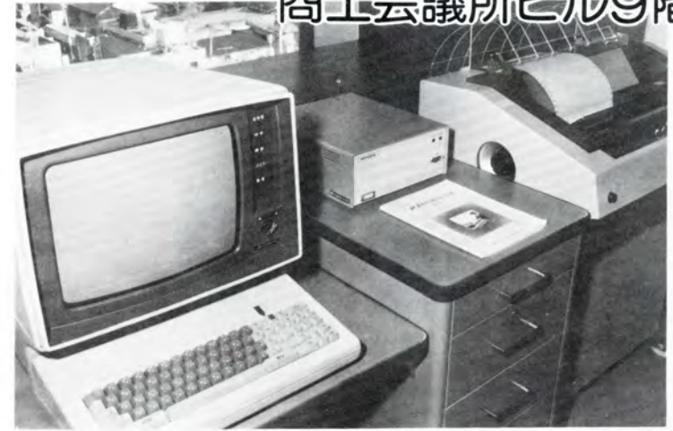
オンライン情報検索用端末機(左側)は必要な情報調査を直ちに行うことができる
