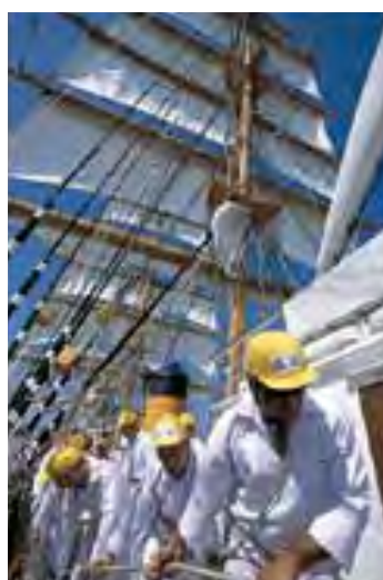
何本もあるロープをみんなで引いて帆を張っていく。マストは、前からフォア、メイン、ミズン、ジガーの4本。約1時間半ですべての展帆を完了する。総帆展帆は年に10回程度行われ、雨や強風の日、中止になることもある。
