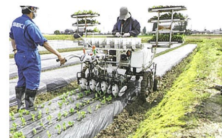
写真2 野菜移植機による定植
