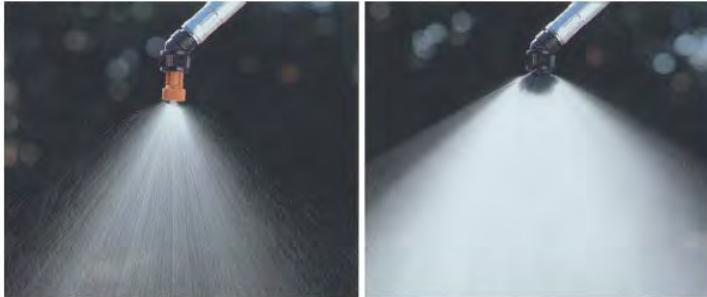
図2 散布粒径が粗いノズル(左)の使用による農薬の散布状況
