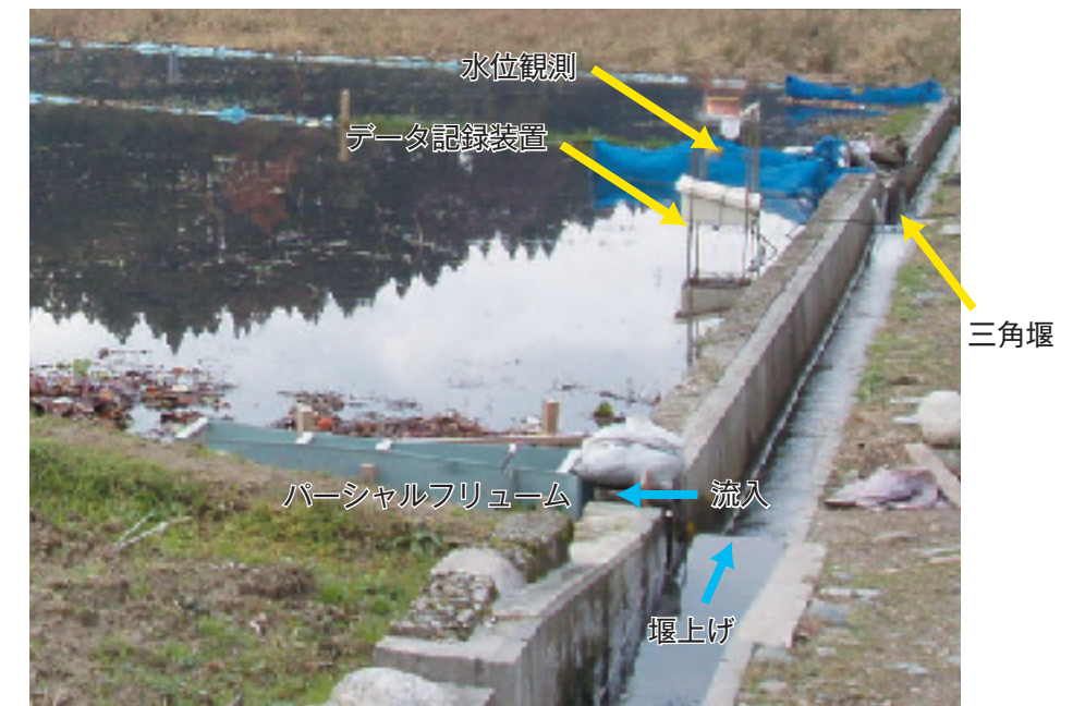
導水・排水設備の設置例
