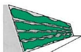
植栽が可能な構造の擁壁
