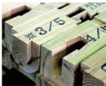
グレーディングマシンで強度や含水率等を印字した製材品
