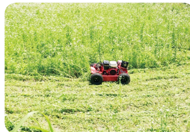
リモコン式草刈機による除草作業
