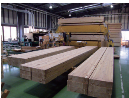
体育室に用いられた接着重ね梁
