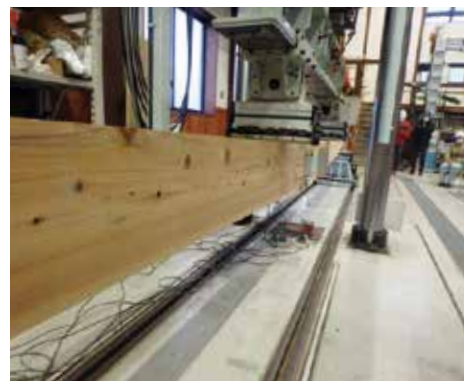
長尺縦継ぎ梁の曲げ破壊試験
