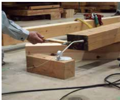
マイクロフォンを用いた固有振動数の計測
