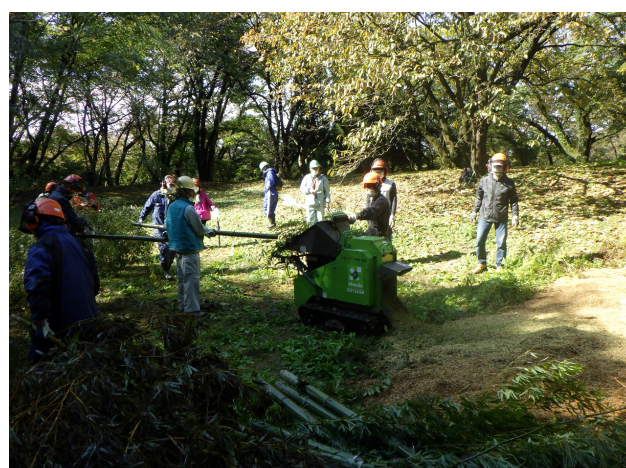
伐採した竹を活用するため、チップパー機により破碎し、遊歩道に竹チップを散布
