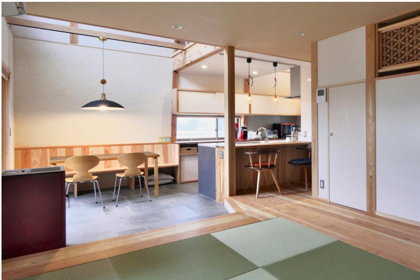
1階、タイル張りの土間と畳敷きのリビング。奥の壁が手前側に傾斜し、吹抜けの解放感を適度に抑えている。無節材は1階に、節の多いものは2階に使用するなど、選木を徹底することで空間の質を調整している。
