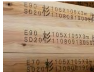
グレーディングマシンで強度や含水率(乾燥の度合い)を印字した製材品
