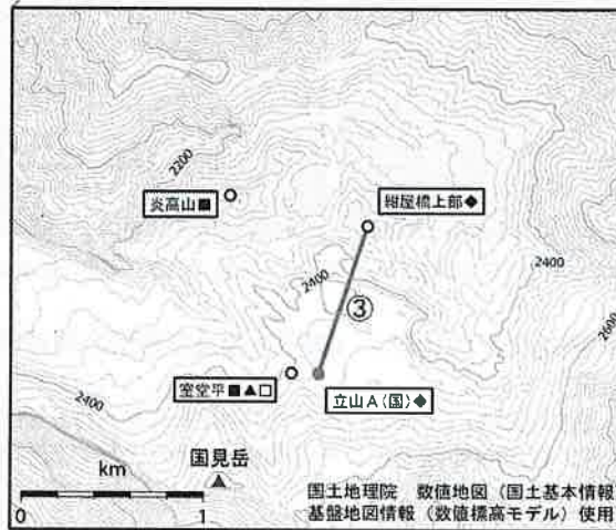
図8 弥陀ヶ原 観測点配置図 図中のGNSS基線③～⑥は図3の③～⑥にそれぞれ対応しています。
