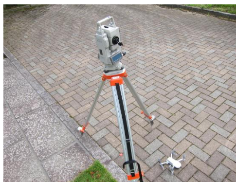
図1 ドローン及びトータルステーション
