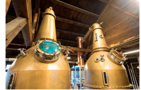
写真：鑄造製ポットスチル「ZEMON」 (高さ4.3m、直径1.8m、容量3000L)
