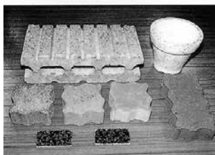
溶融スラグを有効利用したコンクリート二次製品
