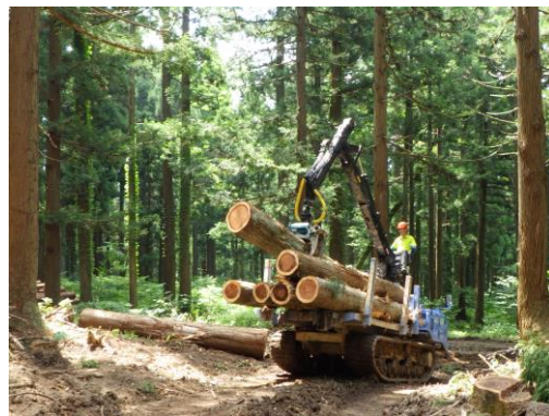
フォワーダによる搬出作業
