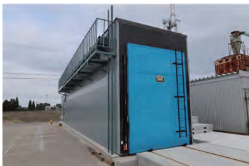
木材加工施設に導入した木材乾燥機 （南砺市専勝寺）
