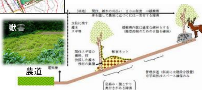
緩衝帯を兼ねた農道整備
