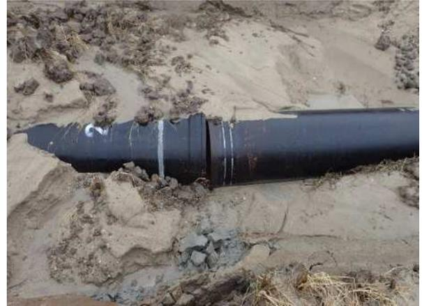
農業用パイプラインが離脱し漏水
