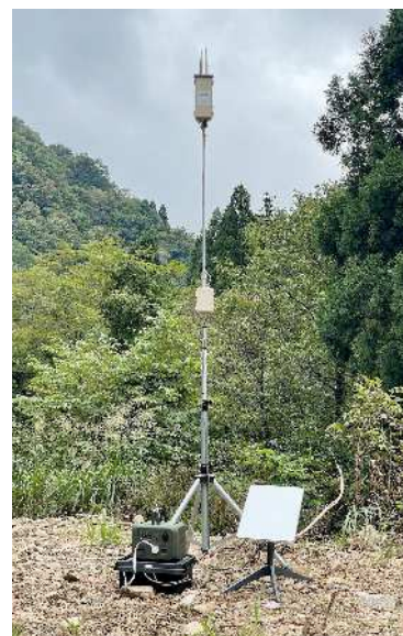
低軌道の人工衛星を活用した林内での通信網の構築
