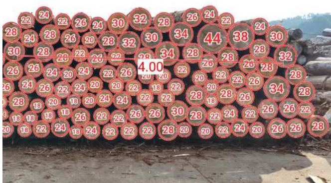
スマートフォンによる丸太の自動計測
