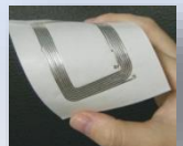
製造工程の環境付加を軽減した無線ICタグ
