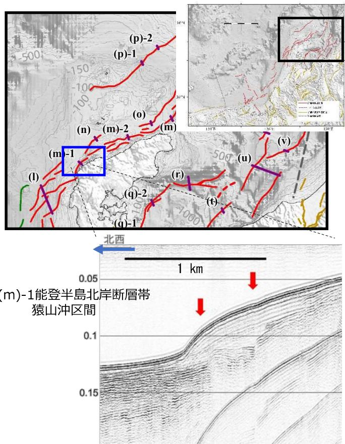
(上図) 評価海域の断層線（赤線）と（下図）反射法地震探査の反射断面の例。
