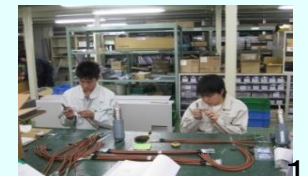
電線切断作業
