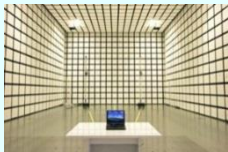
10m法電波暗室
