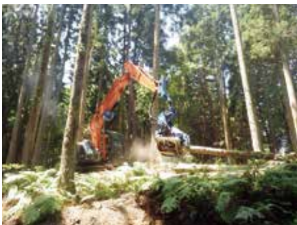
高性能林業機械による伐採
