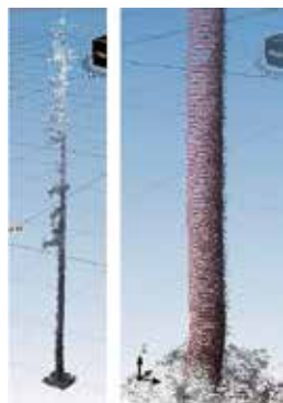
地上レーザによる立木計測
