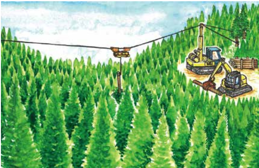
タワーヤーダによる集材
