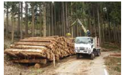
林道沿いに集積された木材の積み込み作業
