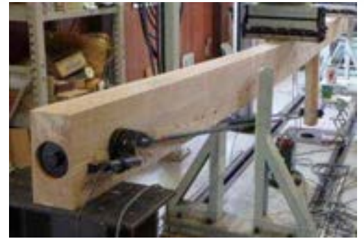
大スパン架構トラスの強度試験の様子
