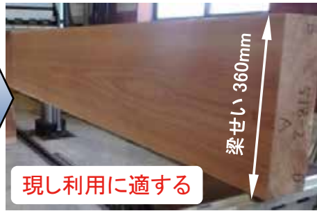
県産スギ大径材から採取した大断面芯去り平角材
