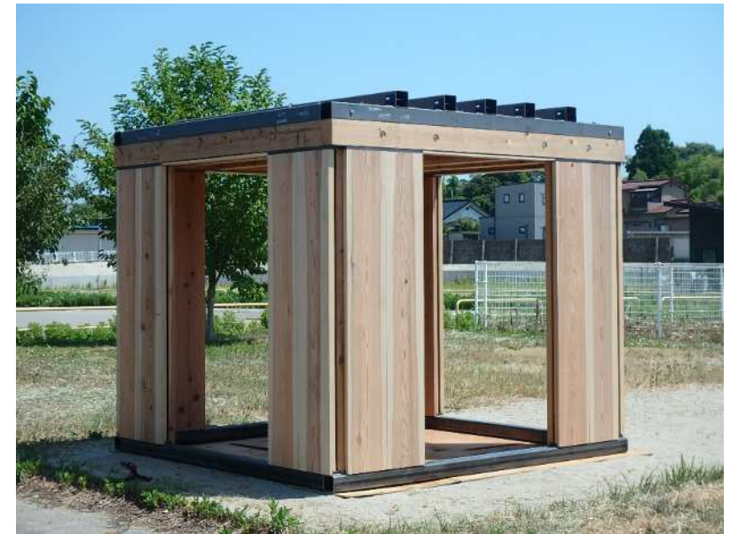
富山型耐震シェルター (富山県木材研究所が開発)
