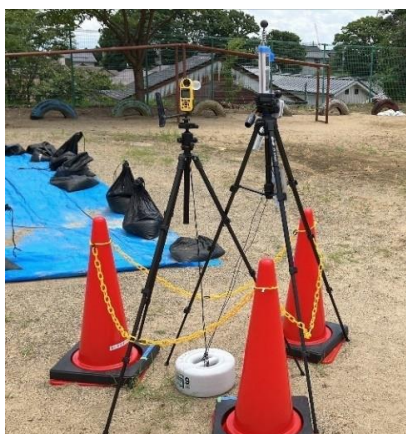
図3 小学校校庭内でのWBGT計測の様子
