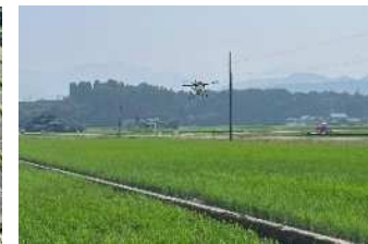
高精度位置補正情報サービスを利用した自動飛行
