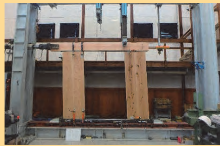
木質架構構造のせん断試験
