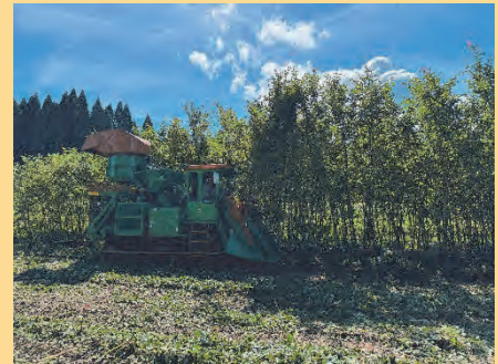
サトウキビ用ハーベスタを用いたヤナギの収穫
