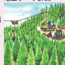
タワーヤード (架線集材)
