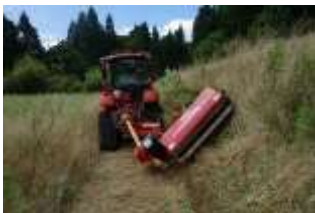
除草作業機械化体系の実証 左:オフセットモア 右:リモコン除草機
