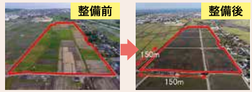
スマート農業を見据えた大区画整備 水橋三郷北地区（1～4ha/筆）
