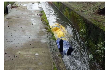
転落者(人型模型)による水位堰上げ状態の再現実験
