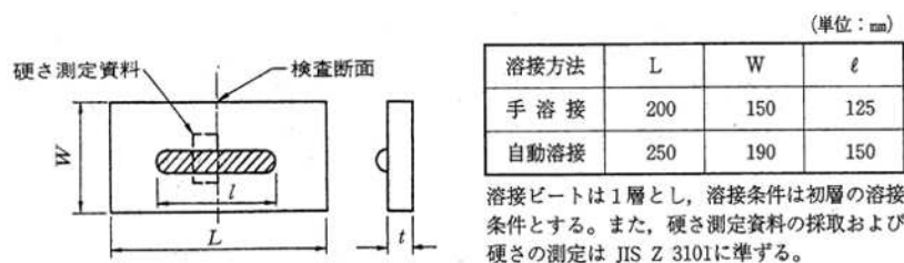
図3-3-4 最高硬さ試験、試験体形状及び試験片採取位置
