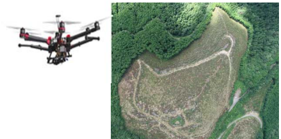
ドローンによる写真撮影測量 (施工管理のコストを低減)
