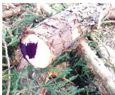
カラーマーキング付きハーベスタ (伐採木の仕分け作業を効率化)
