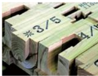
グレーディングマシンで強度や含水率等を印字した製材品
