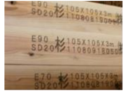
グレーディングマシンで強度や含水率等を印字した製材品
