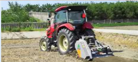
ストーンクラッシャーによる下層礫の破碎作業
