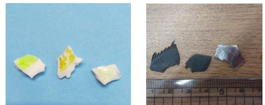
写真4 異物の混入事例 （左：プラスチック片、右：ゴム片）
