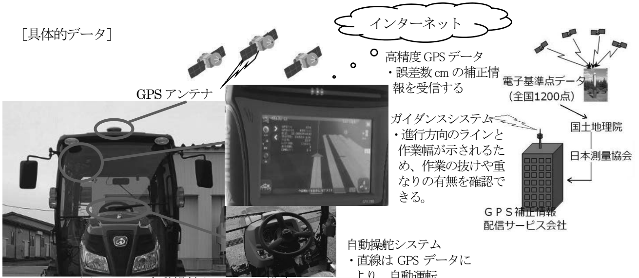
図1 GPS 自動操舵トラクタの構成
