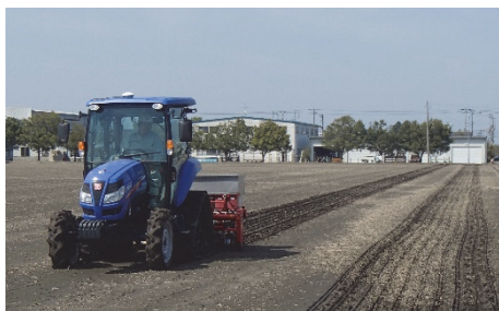
(P. 22) 図2 大区画圃場での GPS 自動操舵による乾田 V 溝直播播種。旋回時間を短縮できる一工程おき作業
