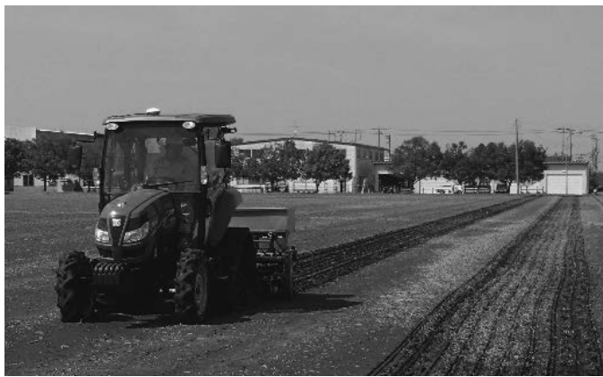
図2 大区画圃場でのGPS 自動操舵による乾田V溝直線播種。巡回時間を短縮できる一工程おき作業。
