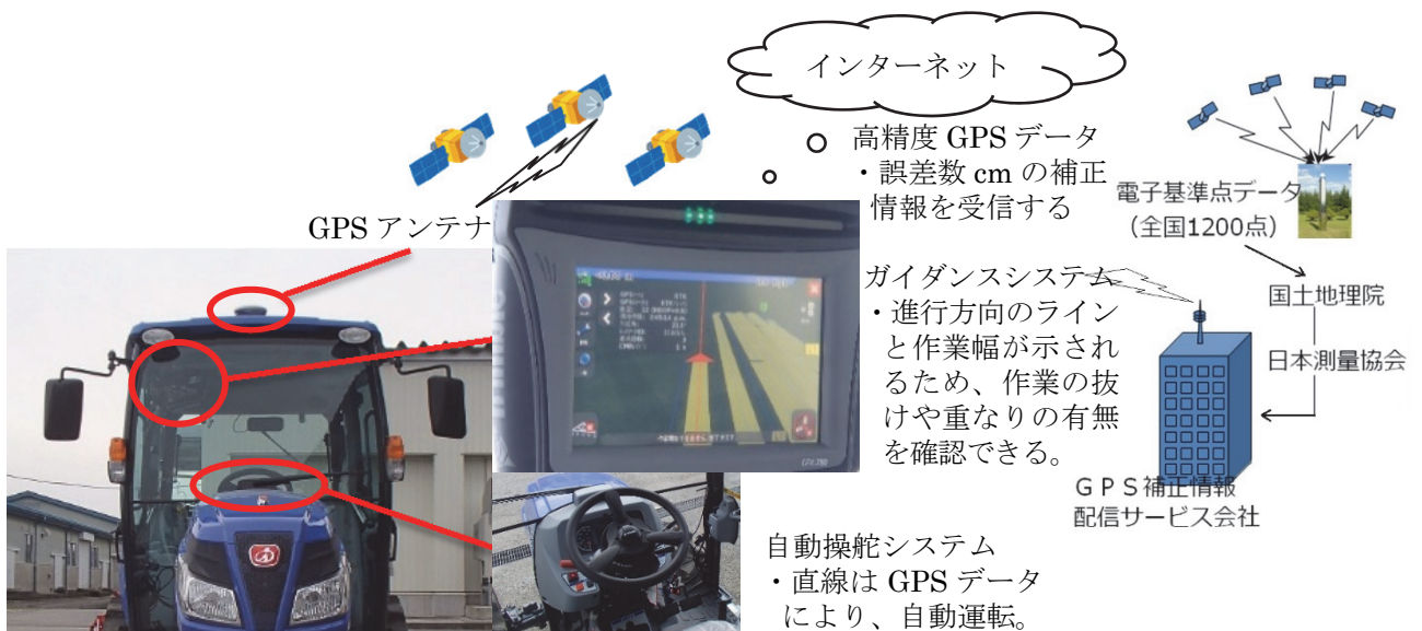
(P. 22) 図1 GPS 自動操舵トラクタの構成
