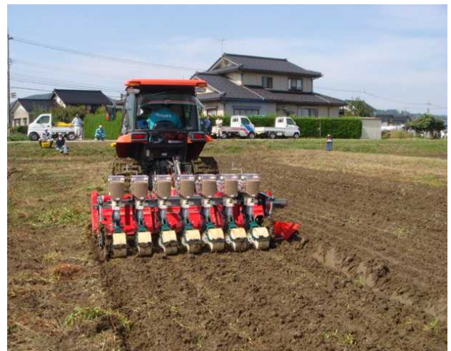
写真3 ドリルシーダーによる「ドリル播き」 耕起、整畦（作溝）、は種、施肥が一連作業
