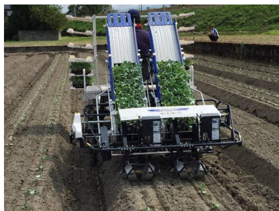
写真2 機械化された定植作業の様子
