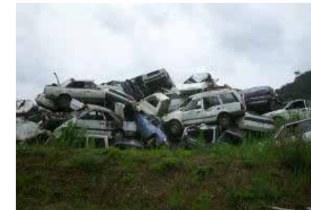
〔乱雑で不適正な積み方の例〕
