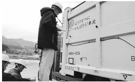
〈搬入時のコンテナの放射線量測定〉
