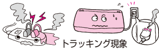
トラッキング現象 電源プラグにほこりや水分が 付いたままにしない
