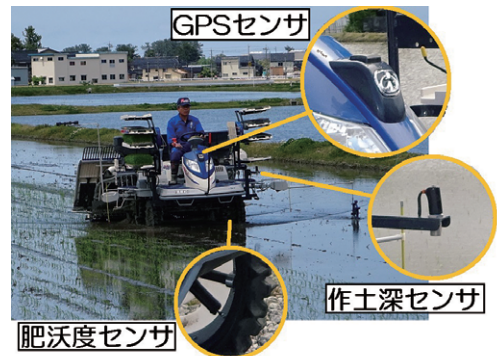
「ロボット農機（可変施肥田植機）」 ～ほ場の肥沃度に応じて施肥量を自動調節～
