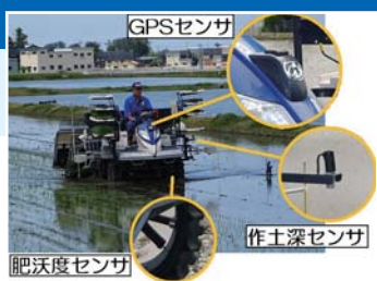
「ロボット農機（可変施肥田植機）」 ～ほ場の肥沃度に応じて施肥量を自動調節～
